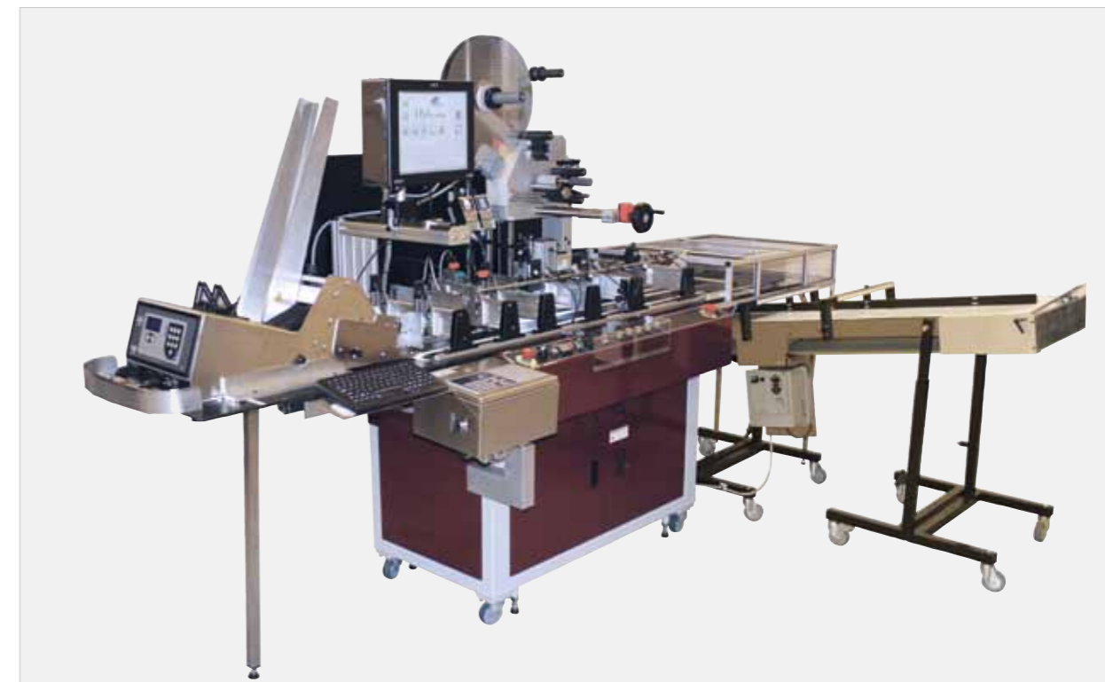
Комплексное решение печати на горизонтально выложенных коробок, разработанное компанией LEO Pharma A/S (Дания). Подача ровно выложенных коробок > Печать 2D Datamatrix - Логотип – Название продукта > Видеоконтроль > Нанесение этикетки > Проверка положения этикетки > Принять или отклонить
